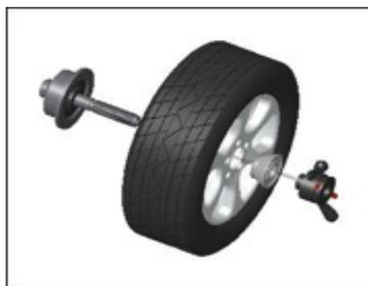
Eixo principal - roda (face de instalação do anel de aço para dentro) - local
